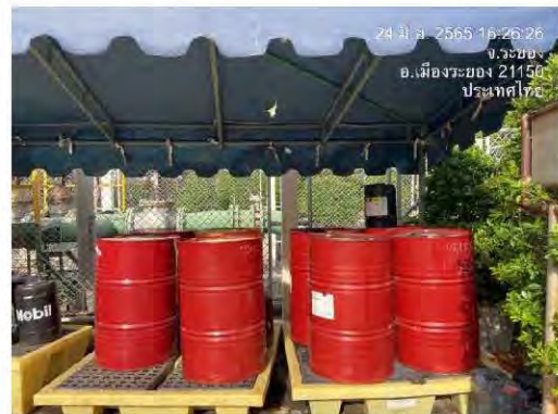
รูปที่ 3.2-28 ถังเก็บน้ำมันเสื่อมสภาพ
