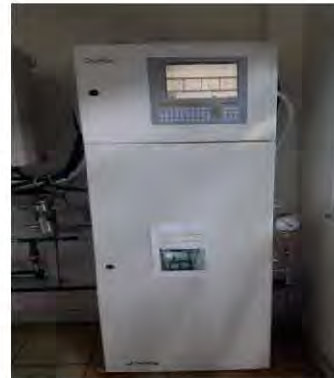
รูปที่ 3.2-55 เครื่องตรวจวัดซีโอดีแบบต่อเนื่อง (COD Online)
